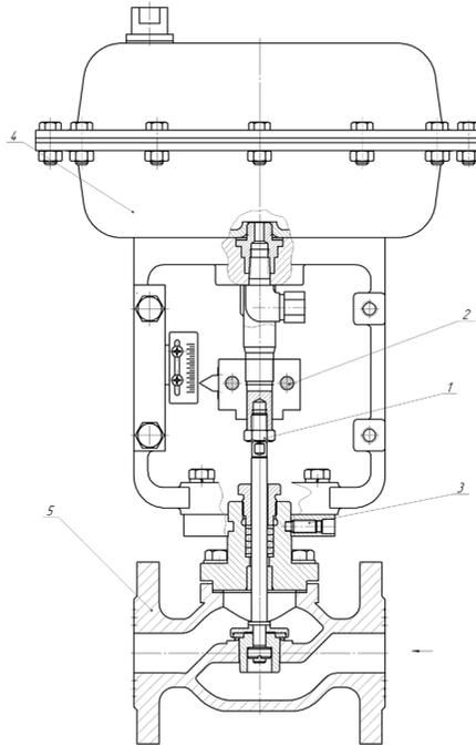
**Демонтаж:** отсоединить линии подачи сжатого воздуха. Ослабить стопорную гайку 1, открутить винты 2 и снять полумуфту со штока клапана и привода. Затем отвернуть стопорные винты 3 и снять пневмопривод 4 с крышки клапана 5.
