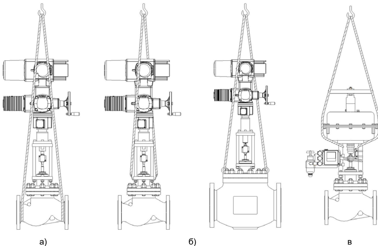
Рисунок 10 – Схемы строповки: а) за проходные патрубки; б) за проушины; в) за стойки привода
