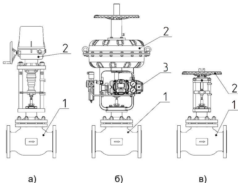
1 - клапанная часть; 2 - исполнительный механизм; 3 - дополнительное оборудование
